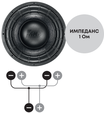
Сабвуферы параллельно, катушки параллельно
