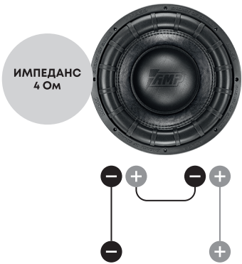
Сабвуферы параллельно, катушки последовательно
